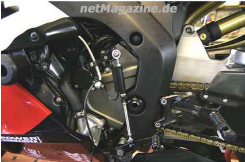
Durch das **vorherige Programmieren** kann der **Schaltautomat** anschliessend wahlweise für **Druckkraft-** oder **für Zugkraft** verwendet werden, welches eine Umkehrung der **Schaltreihenfolge** jederzeit ermöglicht.
