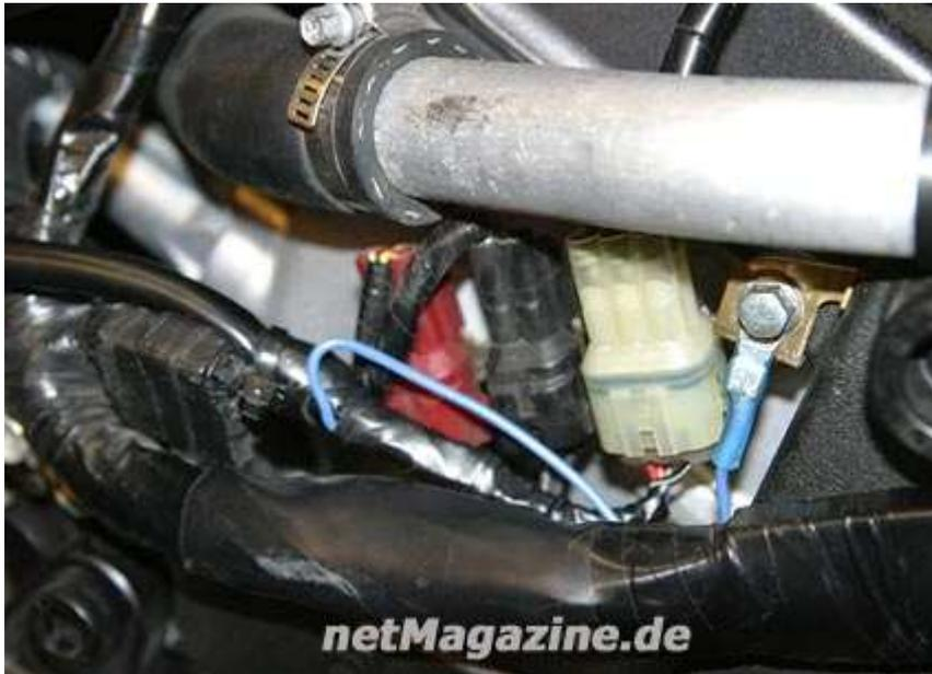
Freilegen der Zündspulanschlüsse
