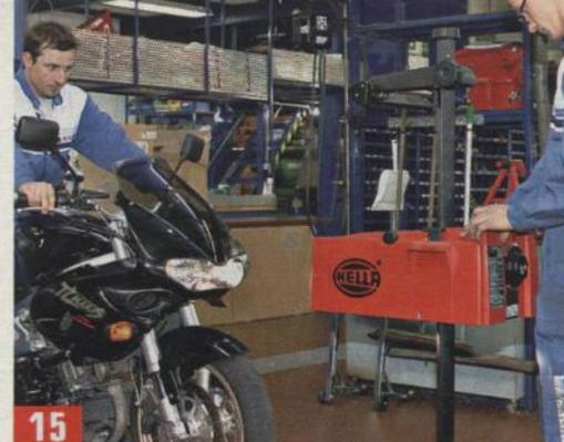
Weiter geht's mit der Kontrolle der Fahrwerkskomponenten. Zunächst ist das Lenkkopflager an der Reihe. Bei angehobenem Vorderrad fahndet der Werkstattmann nach einem falsch eingestellten Lager sowie nach Druckstellen, die die
