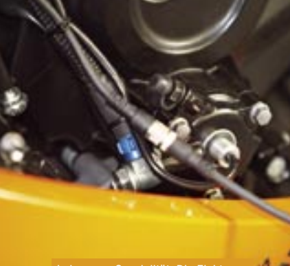
Lohmanns Spezialität: Die Elektrohydraulische Kupplung. Hier der modifizierte Ausdrücker...
