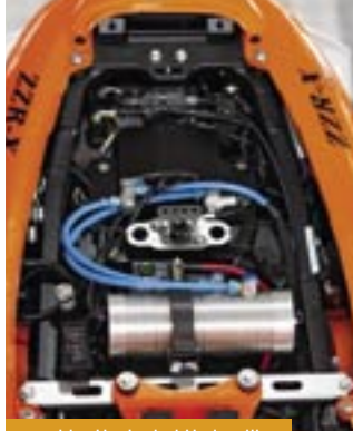
...und im Heck sind Hydraulik-Einheit nebst Steuergerät verstaут.
